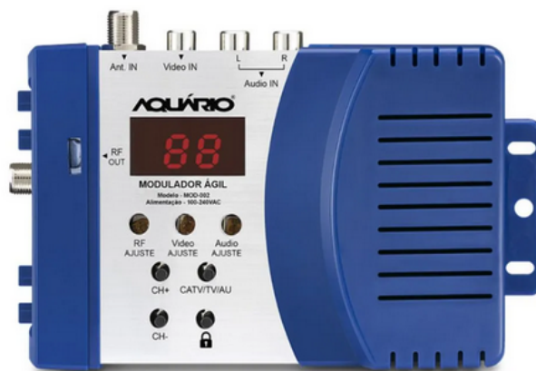
FIGURA 2 – FOTO REPRESENTATIVA DO ITEM 2: MODULADOR ÁGIL DE ÁUDIO E VÍDEO PARA TV/CATV
